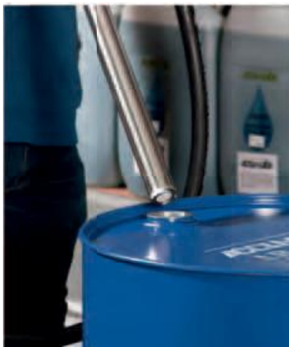
Закрытый обратный клапан препятствует утечке смазочного материала обратно в бочку.
