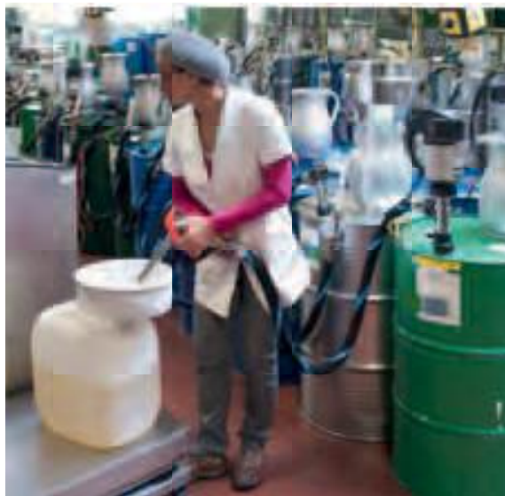
Перекачка эфирного масла (модель F 430 S).
